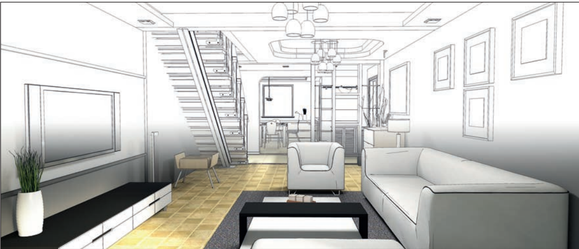
Görsel 2.68: Tek kaçış noktalı perspektif ile iç mekân çizimi
