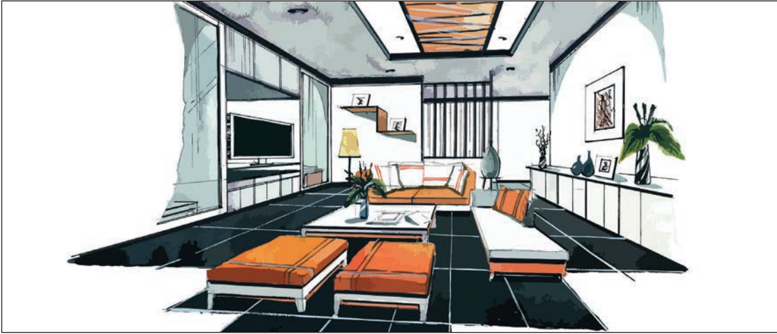
Görsel 2.67: Tek kaçış noktalı perspektif ile iç mekân çizimi
