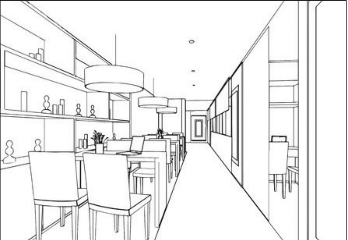
Görsel 2.65: Tek kaçış noktalı perspektif ile iç mekân çizimi
