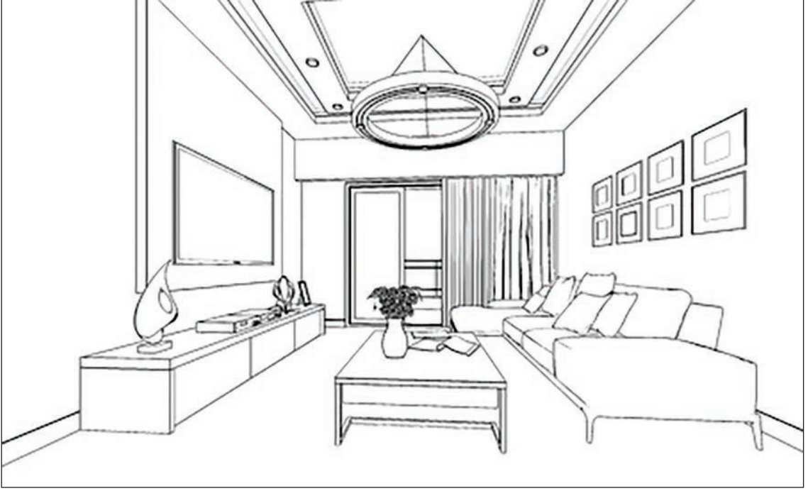
Görsel 2.64: Tek kaçış noktalı perspektif ile iç mekân çizimi
