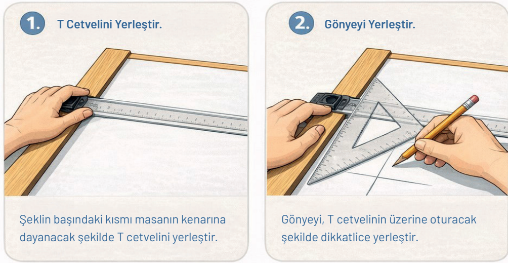
Görsel 1.6: T cetvelinin kullanılması
