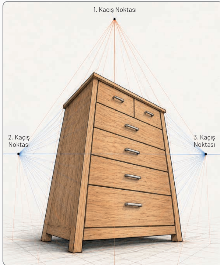
Görsel 2.60: Üç kaçış noktalı perspektif ile komodinin çizimi
