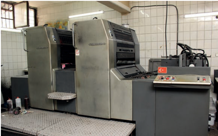
Görsel 1.22: İki renkli ofset baskı makinesi
